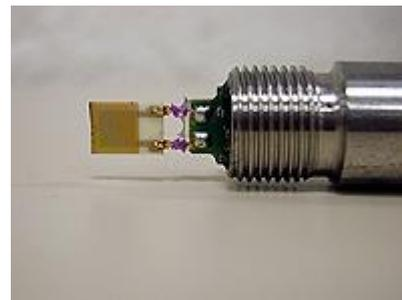
Im Unterschied zur der bei der absoluten Wassergehaltsbestimmung nach der **Karl-Fischer-Methode**, bei der der Gesamtmassenanteil an freiem und gebundenem Wasser in **mg – Wasser / kg – Öl** ausgewiesen wird, erhält man mit dem **WSPS 05** den **Sättigungszustand** des Fluids mit Wasser in **Prozent**.
